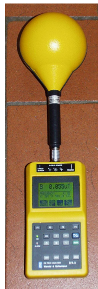
W&G EFA 3 mit E-Feld Würfel & Magnetspule
