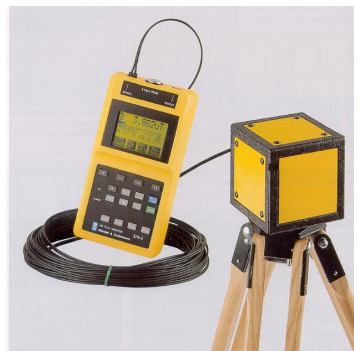
W&G EFA 3 mit E-Feld Würfel & Magnetspule
